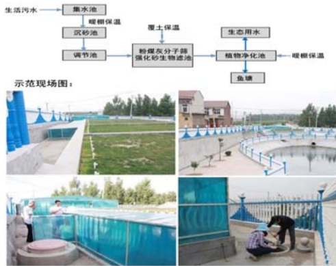
粉煤灰分子筛强化砂生物滤池低温生活污水处理技术工艺流程：
